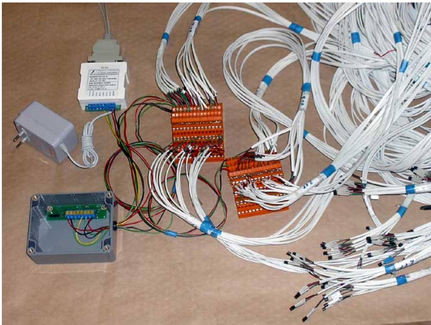
Рис.1. Макет 64-канальной системы измерений температуры с помощью цифровых датчиков фирмы Dallas.
