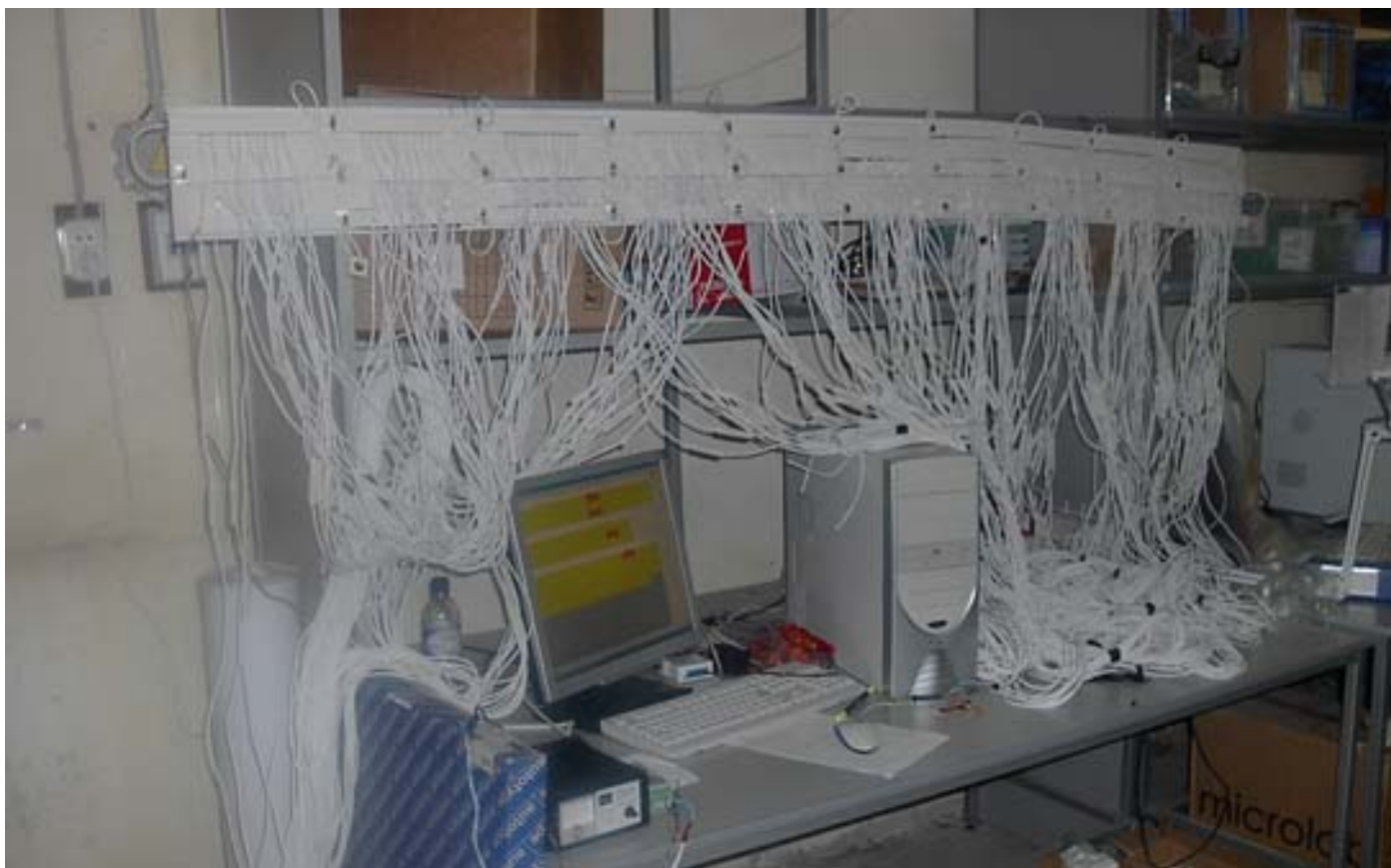
Рис.2. Процесс настройки 300-канальной системы для мониторинга температуры на складе для хранения медицинских препаратов
