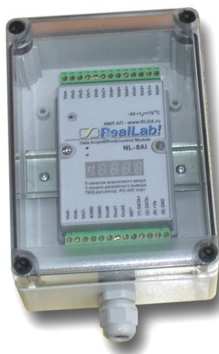
Рис. 6.3. Модуль серии NL в пылевлагозащищенном корпусе IP65
