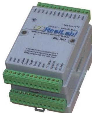
Рис. 4.2. Крепление одного модуля на другой
