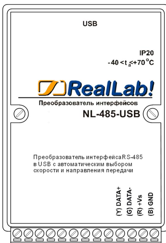
Рис. 1.2. Вид сверху на модуль NL-485-USB-I-P
