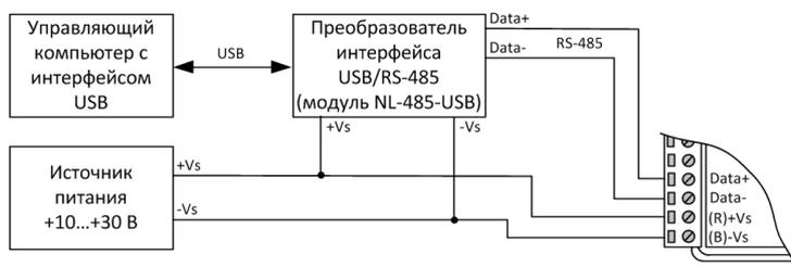
Рис. 4.4. Подключение модуля к порту RS-485 компьютера
