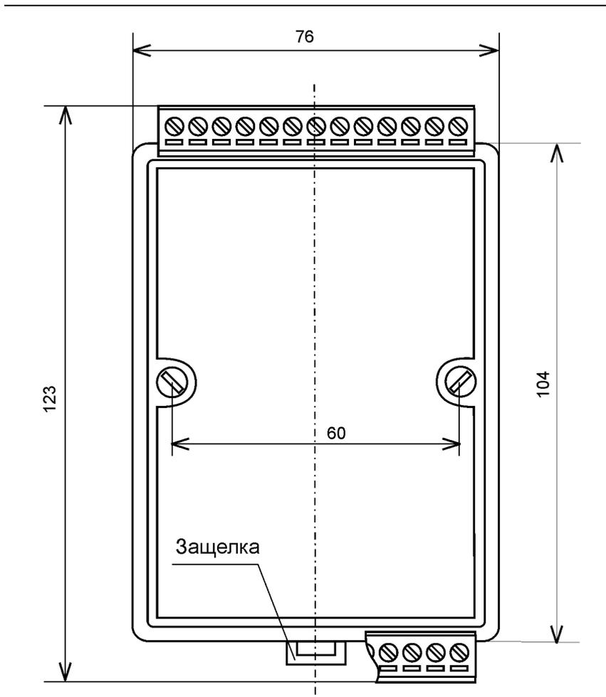
Рис. 1.3. Габаритный чертеж модуля.
