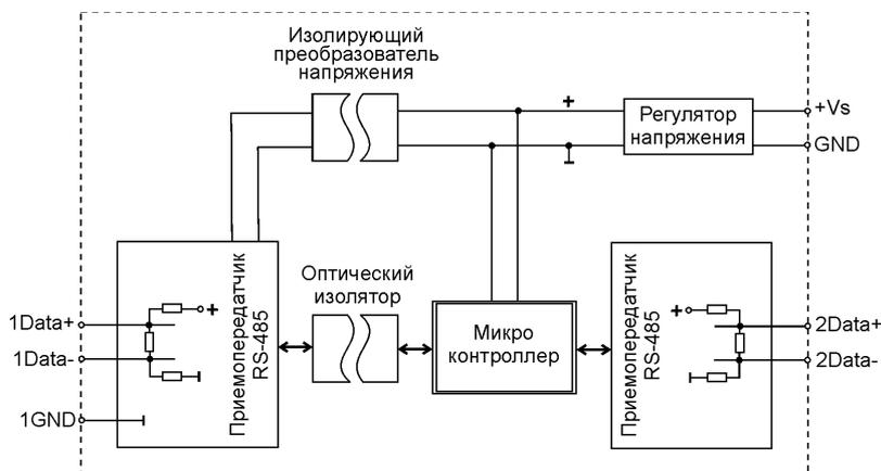
Рис. 3.3. Структурная схема модуля NL-485C-2, в котором источник питания имеет общий провод с интерфейсом (2Data+, 2Data-), но изолирован от интерфейса (1Data+, 1Data-)
