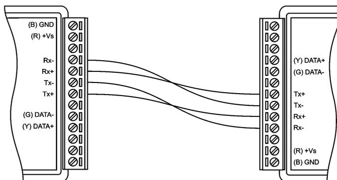
Рис. 4.6. Соединение двух устройств с интерфейсом RS-422
