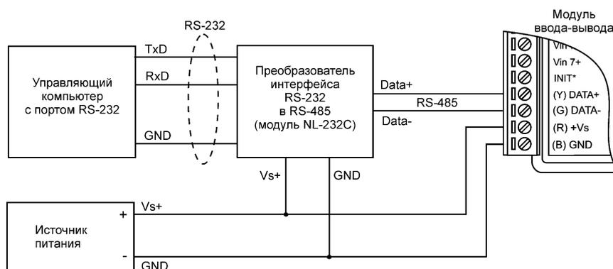
Рис. 4.4. Подключение модуля к порту RS-232 компьютера
