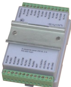
Рис. 6.1. Чтобы закрепить один модуль сверху другого, сначала закрепите DIN-рейку сверху модуля.
