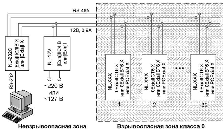
Рис. 4.1. Блок-схема искробезопасной системы на плане взрывоопасных зон
