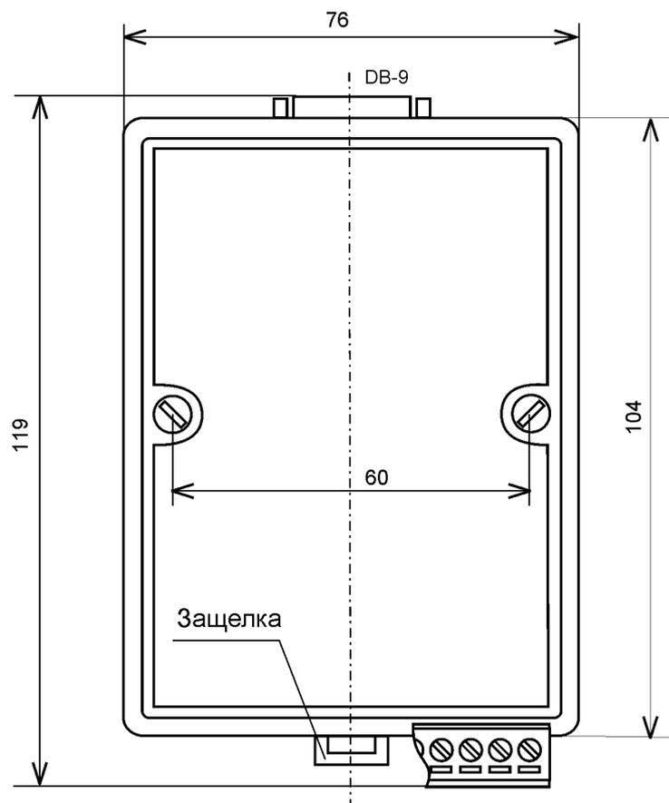
Рис. 1.2. Габаритный чертеж модуля.
