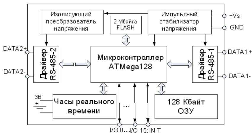
Рис. 3.1. Структурная схема модуля NLcon-1AT
