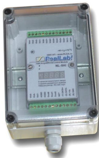
Рис. 4.2. Модуль серии NL, взрывозащищённого исполнения, в пылевлагозащищенном корпусе IP66
