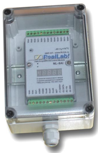
Рис. 6.2. Модуль серии NL, взрывозащищённого исполнения, в пылевлагозащищенном корпусе IP66
