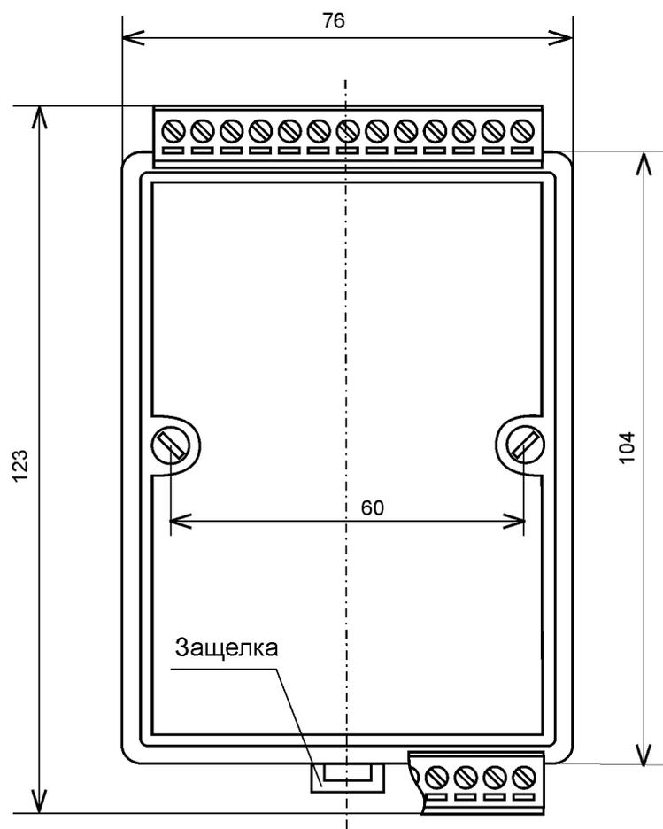
Рис. 3.1. Габаритный чертеж модуля.
