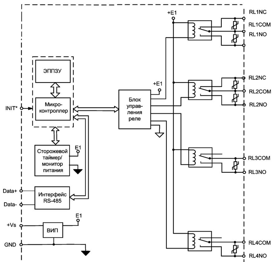
Рис. 4.3. Структурная схема модуля NL-8R. Обозначения: COM - "Common" - "общий", "NC" - "Normal Closed" - постоянно замкнутый, "NO" - "Normal Open" - постоянно открытый
