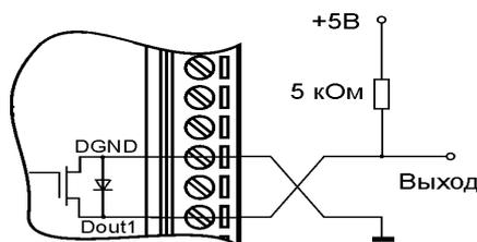
Рис. 5.8. Получение логических уровней напряжения на выходах модуля
