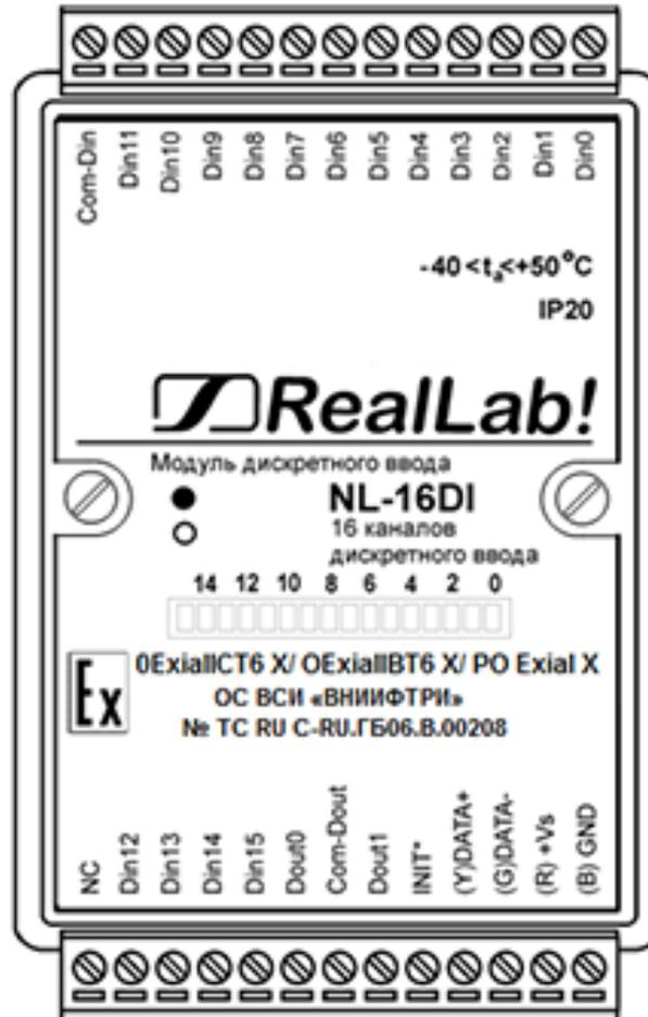
Рис. 2.1. Вид сверху на модуль NL-16DI, взрывозащищённого исполнения
