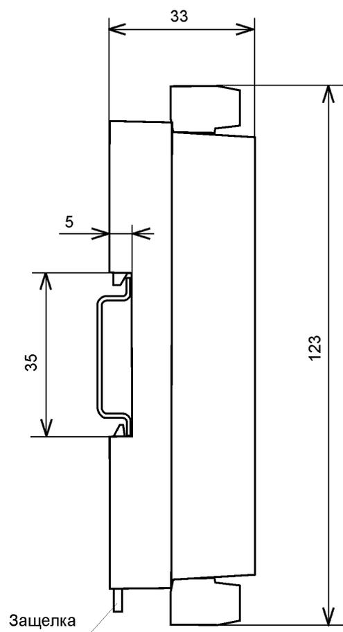
Рис. 3.2. Габаритный чертеж модуля с креплением к DIN-рейке. Планка для крепления к DIN-рейке. Планка для крепления к стене отсоединена. Вид сбоку.
