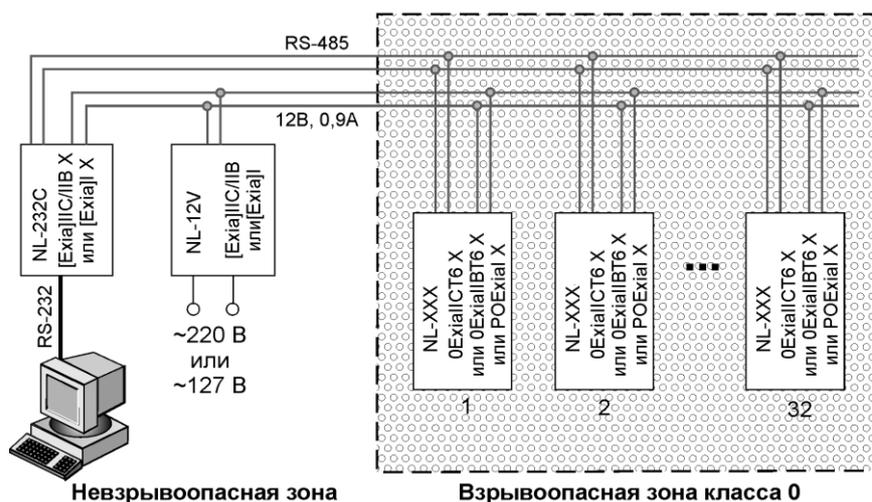
Рис. 5.1. Блок-схема искробезопасной системы на плане взрывоопасных зон
