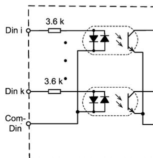
Рис. 4.5. Входной каскад типа InR.  $U_{вх} = -13...+13$  В;  $I_{вх} = -10$  мА...  $+10$  мА.
