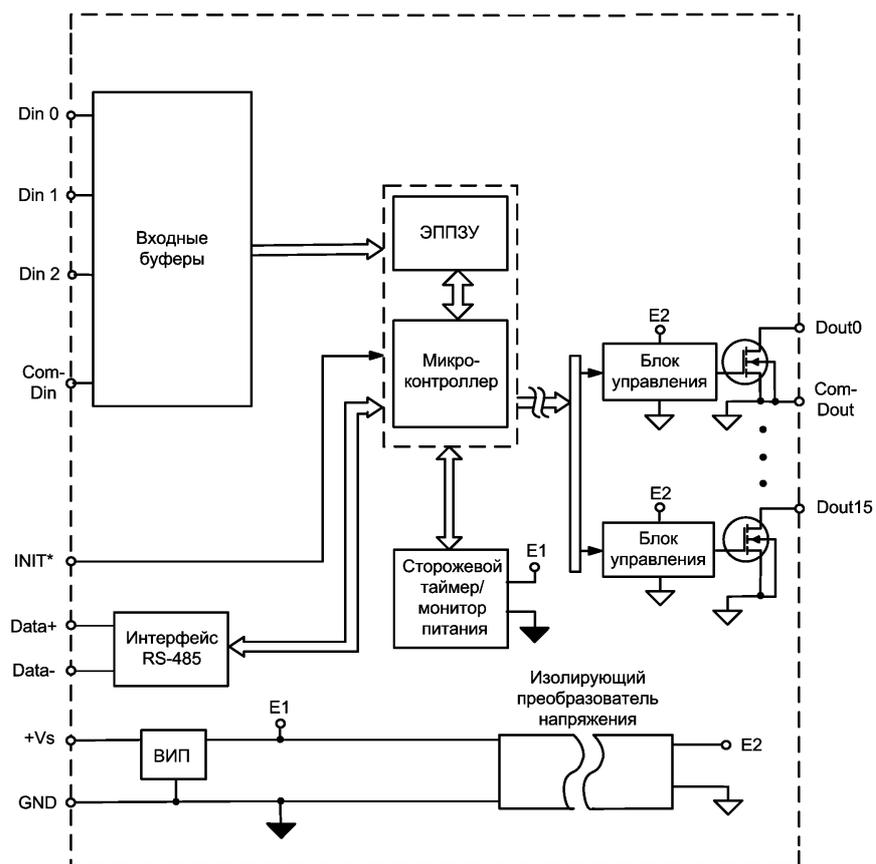
Рис. 4.2. Структурная схема модуля NL-16DO, взрывозащищённого исполнения
