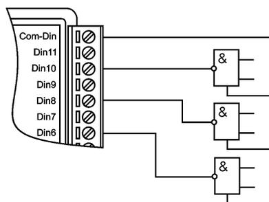
Рис. 5.7. Подсоединение источников сигналов с логическими уровнями
